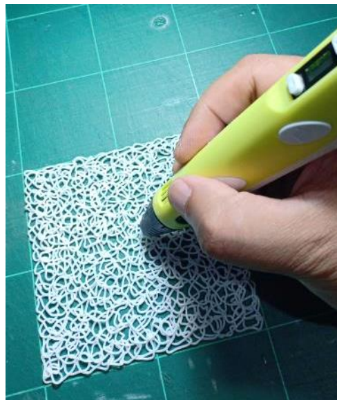
Gambar 11. Teknik 3D Pen Interaksi Langsung Antara Tangan Dengan Alat Bantu dan Filamen PLA [Sumber: Dokumentasi Peneliti, 2024]
