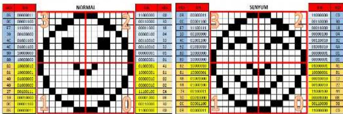
Gambar 6. Kode pada display Dot Matrik LED ukuran panel 16 x 16.
