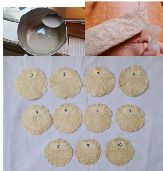
Gambar 11. Proses Pembuatan & Hasil Lembaran Pulp Serat Nanas
