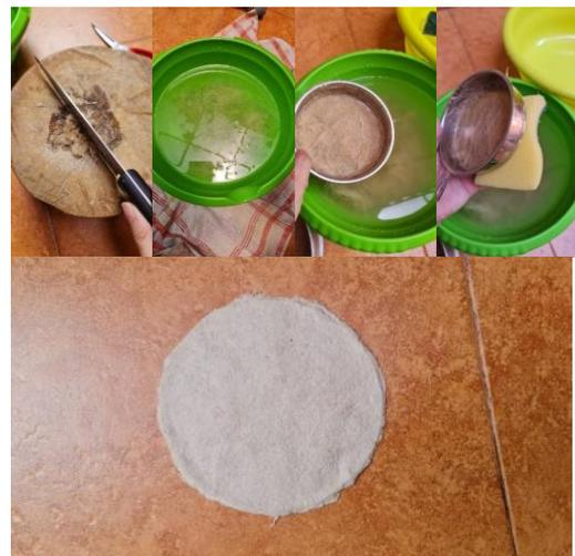
Gambar 10. Proses Pembuatan & Hasil Lembaran *Pulp* Serat Nanas
