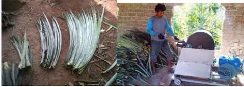
Gambar 3. Proses 1&2 Produksi Serat Daun Nanas
