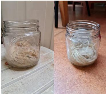
Gambar 8. Hasil Perendaman Serat Nanas di Larutan H<sub>2</sub>O<sub>2</sub>
