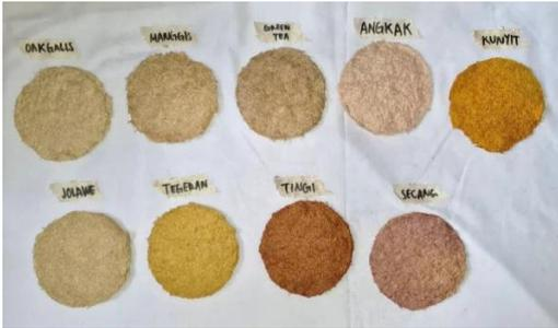
Gambar 13. Hasil Eksperimen Serat Nanas dengan Pewarna Alami
