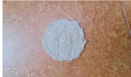
Gambar 9. Proses Pembuatan & Hasil Lembaran Serat Nanas Potongan Kecil
