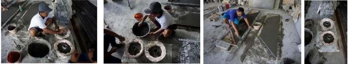
Gambar 3 Menuangkan adonan ke cetakan
